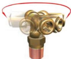
A linha de conexões Push-in® DOT da Parker possui tees e cotovelos com roscas macho orientáveis que permitem girar a conexão 360° para a instalação em lugares de difícil acesso e para posicionamentos precisos. Um anel de Buna-N garante a vedação entre o corpo da conexão e o plug roscado.
