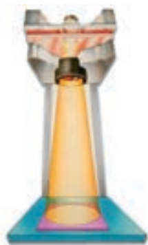
Uma fonte de luz é focalizada por meio de uma coluna em movimento de óleo.
